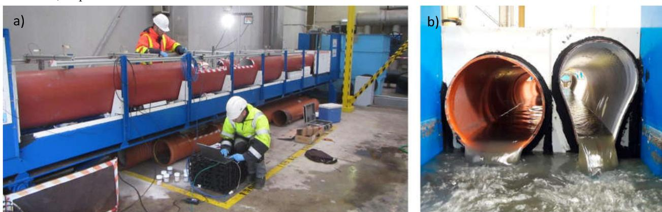
Figura 1 | Plataforma experimental situada en la EDAR de Bens (a) con la configuración de ensayo de tubería ovoide y circular (b).
