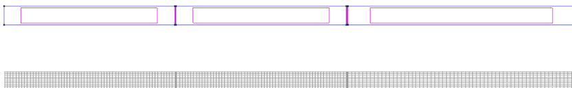
Figura 2. Geometría y malla empleadas para las simulaciones con caudal constante
